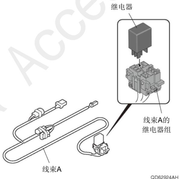
46. 连接线束 A 的接线器。
