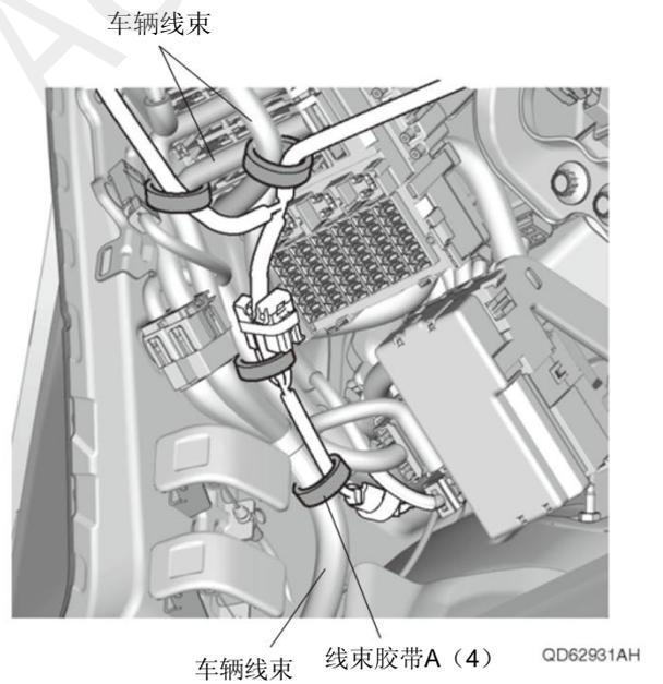
55. 连接线束 A 的接线器。
